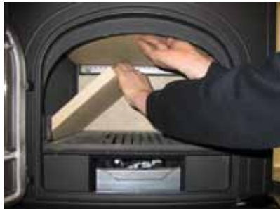
b. Soulevez légèrement la chicane inférieure et maintenez-la en place. Soulevez avec précaution les deux briques latérales et retirez-les.
