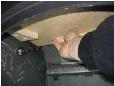
e. Retirez la chicane supérieure des supports, soulevez-la et retirez-la de la chambre de combustion
